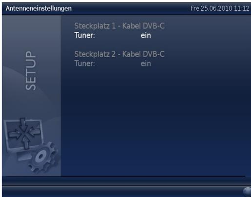
Falls weniger Tuner genutzt werden, als in ReelBox oder NetCeiver verbaut sind, sollten nicht benutzte Tuner über das Setup Menü abgeschaltet werden.
